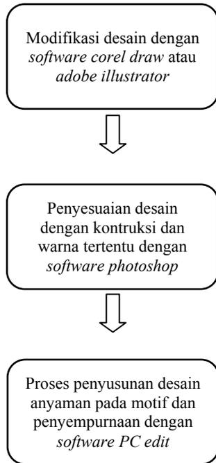
**Gambar 5.** Tahapan proses pembuatan desain pada mesin tenun *jacquard* elektronik
